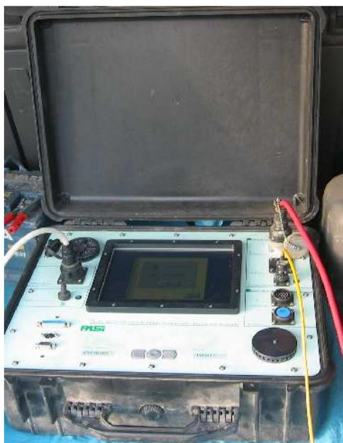
Centralina Pasi utilizzata per indagine geosismica a rifrazione
