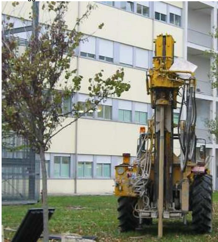
Trivella idraulica utilizzata per i sondaggi a carotaggio continuo
