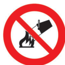
Забороняється гасити водою
