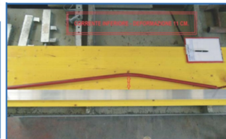
Figura 15 - Deformazione dopo l'impatto del corrente inferiore
