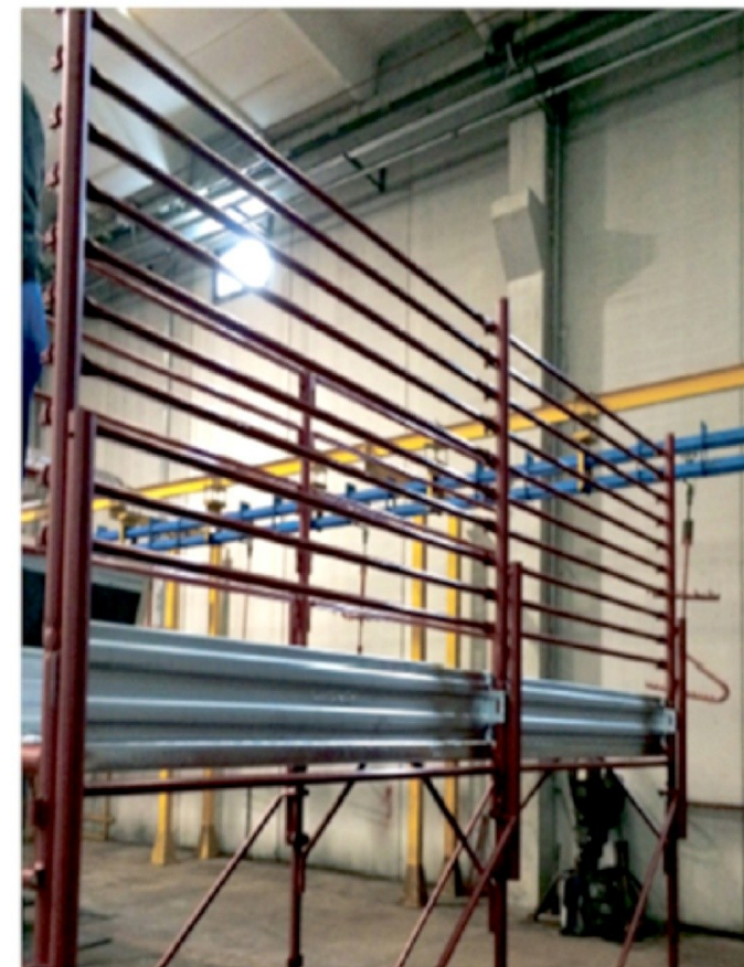
Figura 5.1.1-2 - Esempio di prototipo di parapetto di sommità a perni
