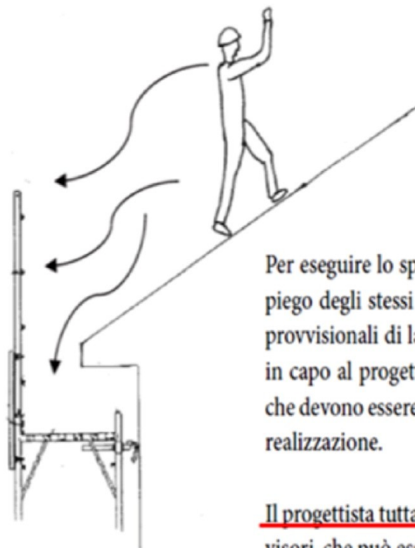
Figura 5.1.2-1 - Lavoratore in caduta lungo il pendio di una copertura [Fab-015]
